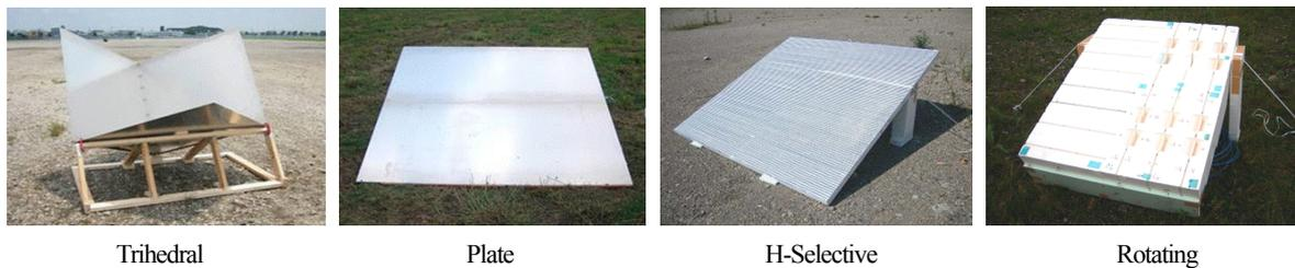
Fig.3 校正実験に用いた反射器の外観
